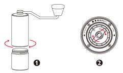
向下旋出粉碗,在主机身下端调整至所需的研磨粗细度。
